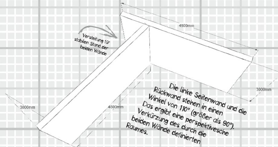
Die linke Seitenwand und die Rückwand stehen in einen Winkel von 110° (größer als 90°). Das ergibt eine perspektivische Verkürzung des durch die beiden Wände definierten Raumes.
